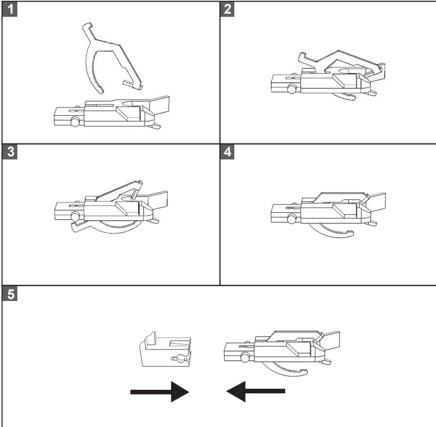
**Achtung:** Bei der Montage darf der Kupplungshaken nicht verbogen werden, da die Kupplungsfunktion sonst nicht mehr gewährleistet ist.
