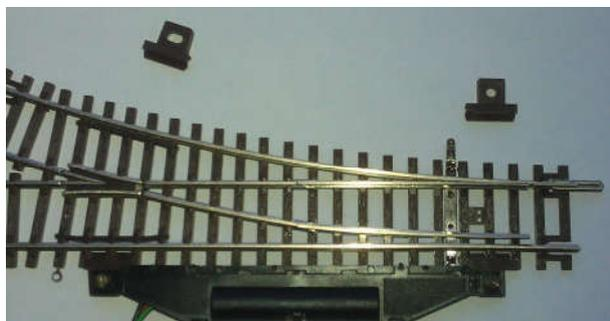
Anschließend wie gewohnt den Antrieb befestigen. Die nicht benutzten Anschlussböcke können entfernt werden.
